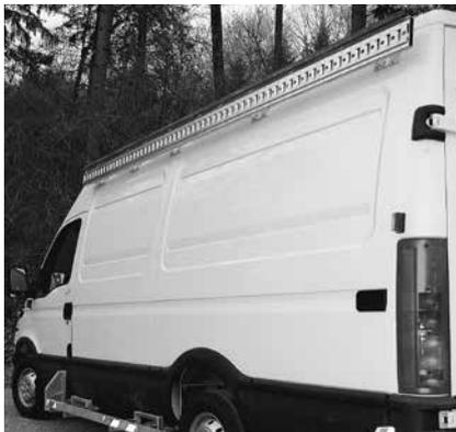
Seitlicher Lastenträger zum Beispiel für den Transport von Türen
