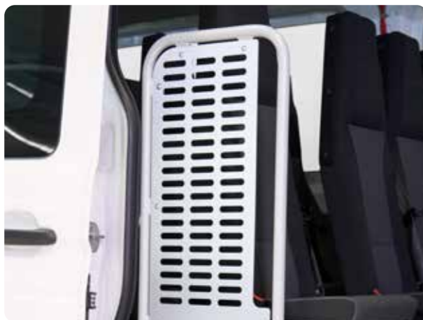
Barre de maintien avec tôle (protection supplémentaire contre le coincement des doigts)
