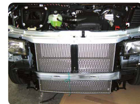
Protection capot et moteur en tôle perforée en acier inoxydable
