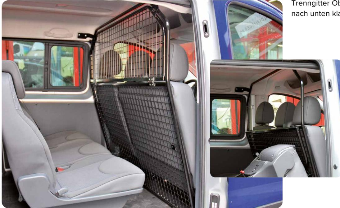
Trenngitter Oberteil nach unten klappbar
