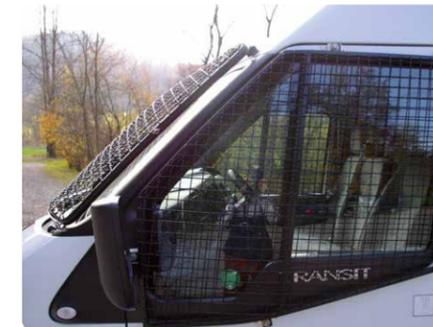
Schutzvergitterung – Seitenscheiben Fahrerraum
