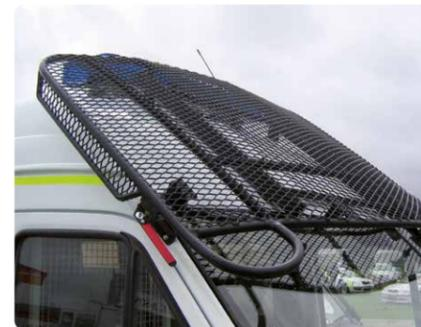
Schutzvergitterung – Frontscheibe nach oben schiebbar
