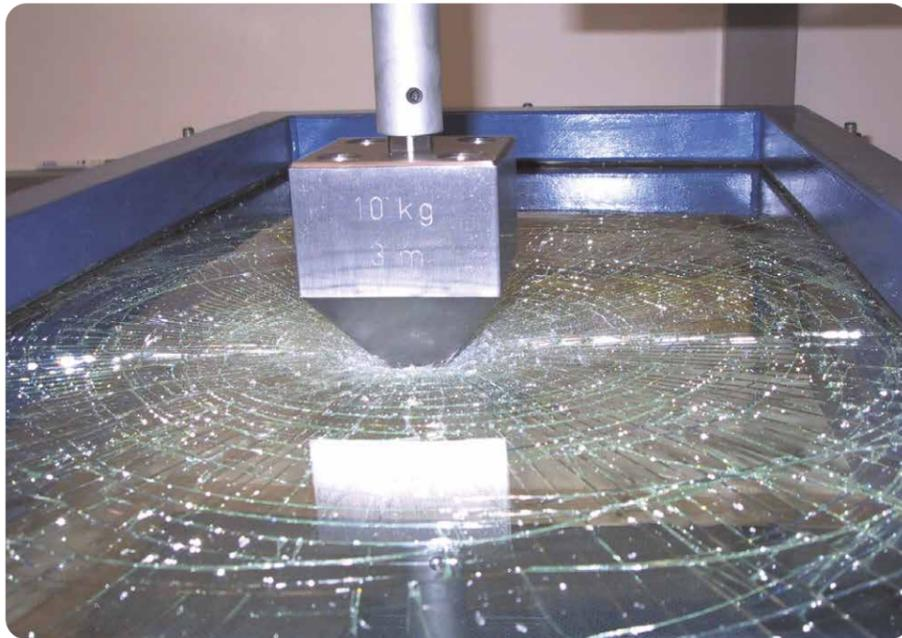
**Prüfung einer verstärkten Verbundglasscheibe**
