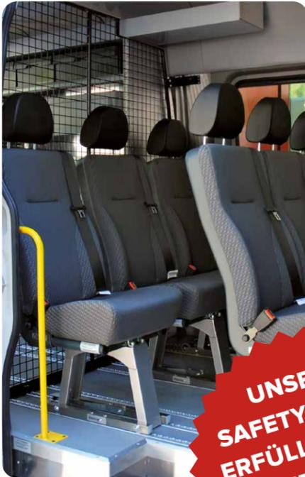
Einzelsitz mit Schnellverschluss auf der gesamten Laderaumlänge verschiebbar und demontierbar (auf Wunsch drehbar)
