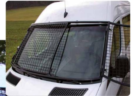
Schutzvergitterung – Frontscheibe klappbar
