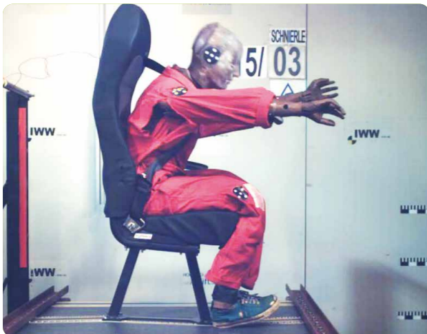
Crash-test (test sur chariot) avec un dummy. Le plancher et le siège sont testés.
