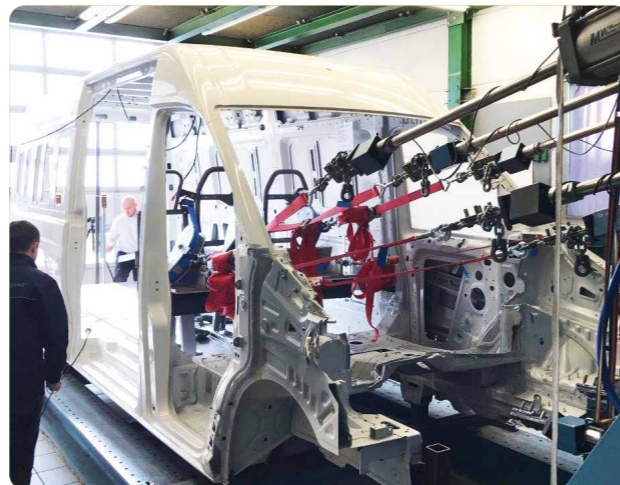
Essai de traction sur le véhicule. L'ancrage du plancher et des sièges est testé directement dans le véhicule.
