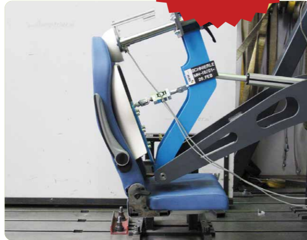
Test d'impact au niveau de la tête.
