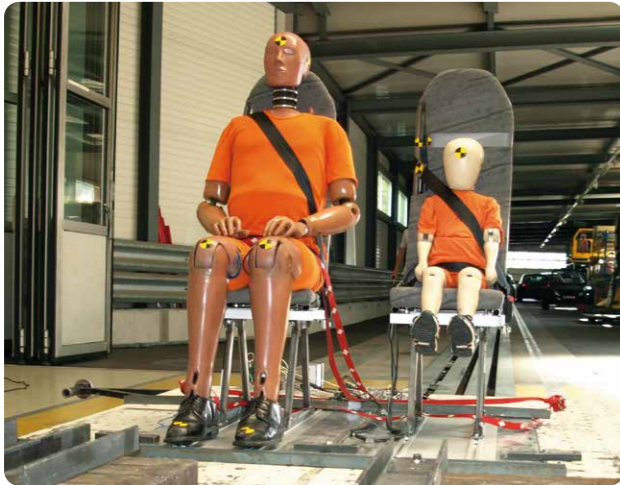
Prüfung der Befestigung einzelner Sitze in Verbindung mit einem bestehenden Boden.
