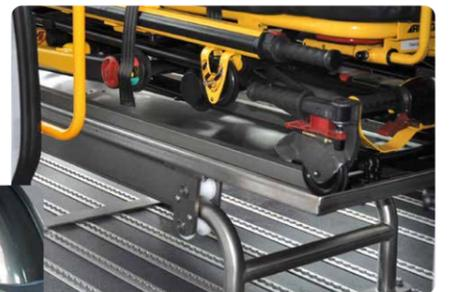
Rollstuhlverankerung auf Safety-Boden™ montiert
