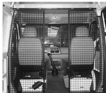
Paroi de séparation type B avec passage
