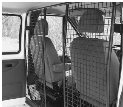
Paroi de séparation type B avec passage
