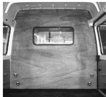
Paroi de séparation type C avec fenêtre
