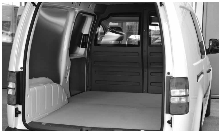
Revêtement du plancher et des parois latérales
