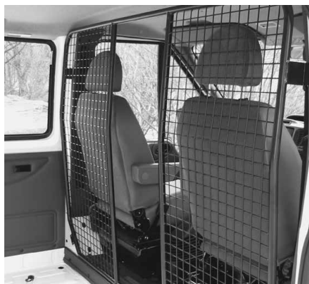
Paroi de séparation type B avec passage
