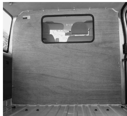
Paroi de séparation type C avec fenêtre
