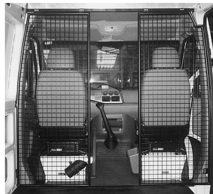
Paroi de séparation type B avec passage
