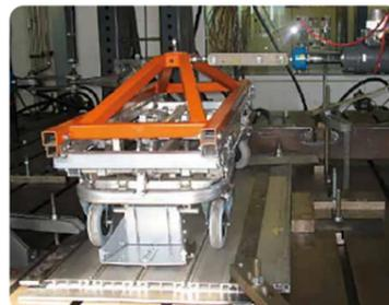
Essai de traction en sens transversal
