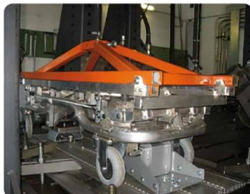
Essai de traction en direction verticale vers le haut
