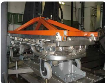
Zugversuch in Vertikalrichtung nach oben
