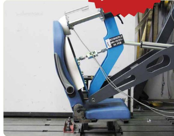
Test hinsichtlich eines möglichen Kopfaufpralls.
