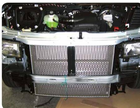
Protection capot et moteur en tôle
