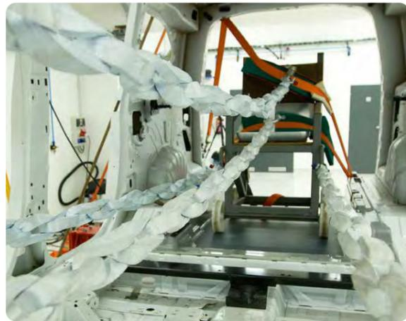
Zugversuche zur Prüfung der Rollstuhlverankerungen im Fahrzeug.
