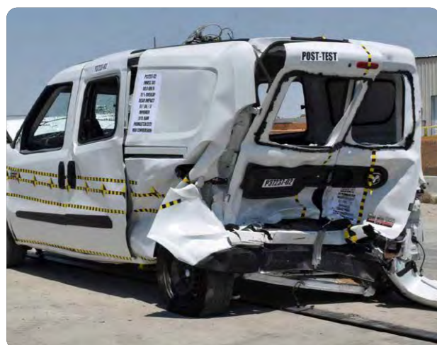
Essai de collision: Après collision arrière par un autre véhicule
