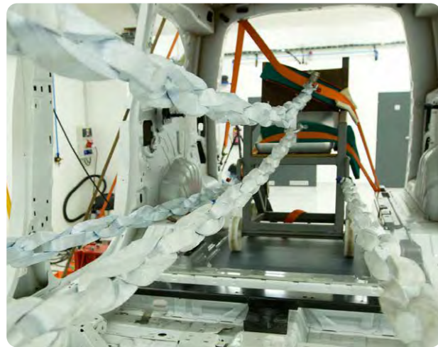
Zugversuche zur Prüfung der Rollstuhlverankerungen im Fahrzeug.
