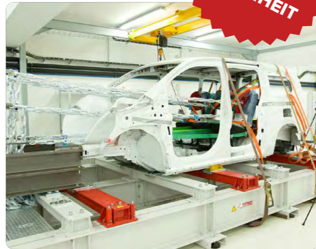
Prüfungen der zusätzlichen Sitze, Safetrans™ und SafetransPlus™ in Verbindung mit unserem Heckausschnitt.
