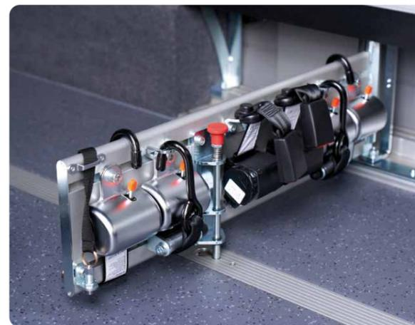
09 Diverses positions de fixation et possibilité de déplacer les bras de support pour un arrimage sûr de fauteuils roulants de différentes longueurs
