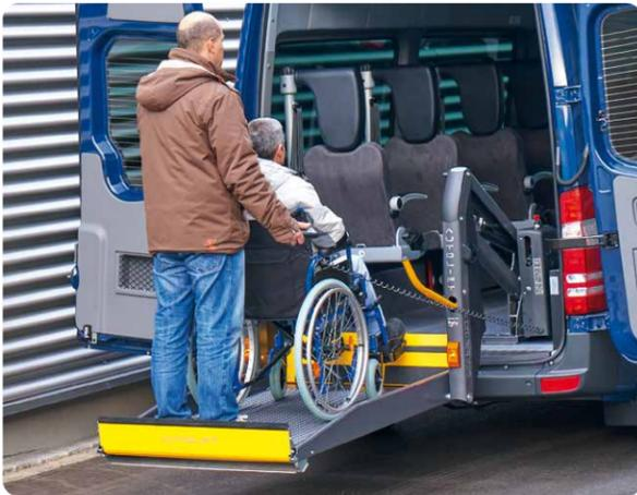
01 Entrée aisée par plate-forme élévatrice
