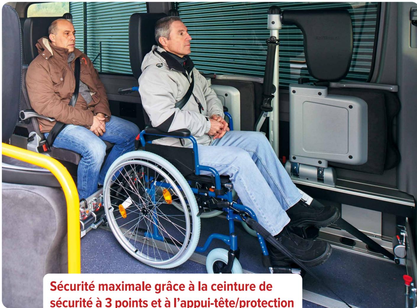
**Sécurité maximale grâce à la ceinture de sécurité à 3 points et à l'appui-tête/protection dorsale réglable pour une position optimale**
