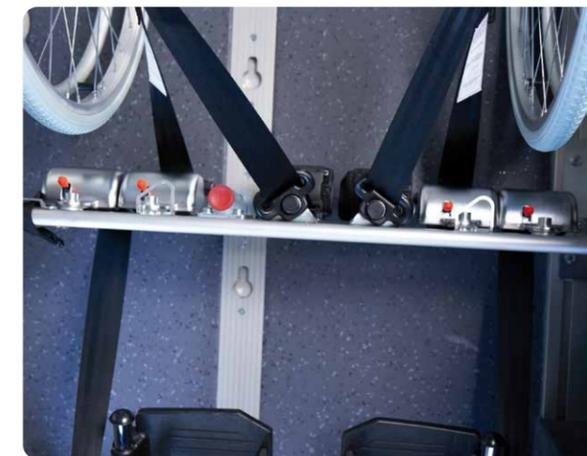
10 Tout se trouve sur le bras de support central: arrimage du fauteuil à l'arrière et ceinture ventrale pour le fauteuil roulant à l'avant. Arrimage à l'avant pour le fauteuil roulant à l'arrière
