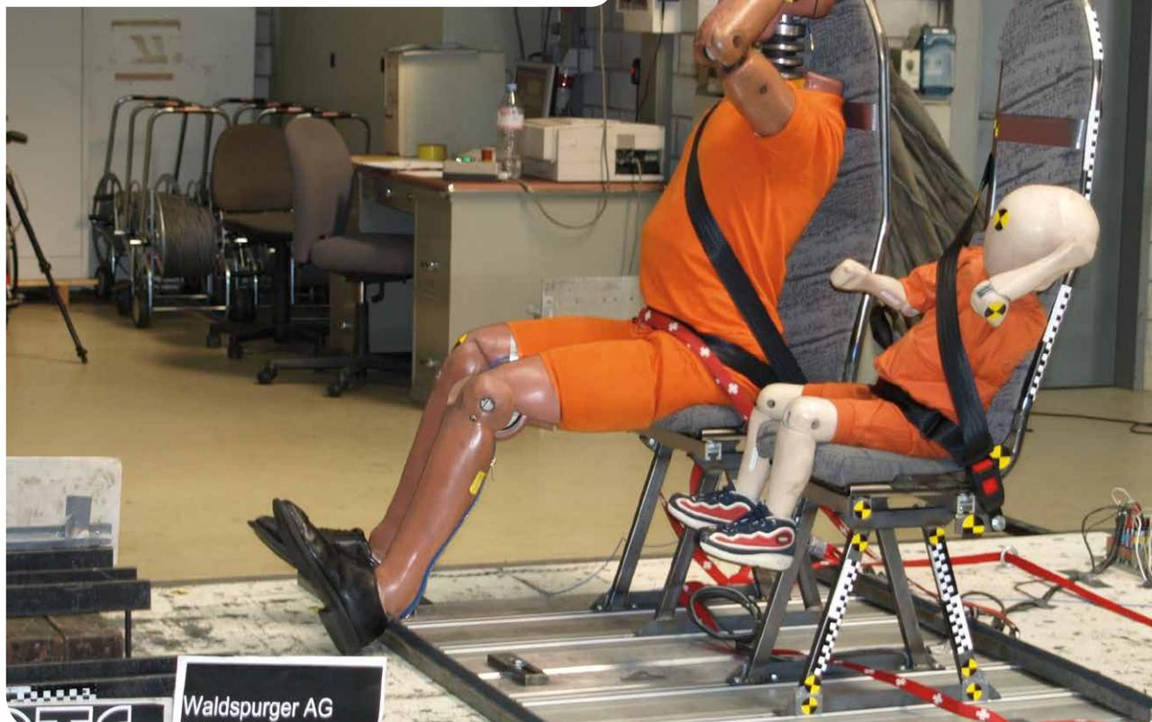
Nach bestandener dynamischer Prüfung des Safety-Schulbussitzes™ am DTC in Vauffelin
