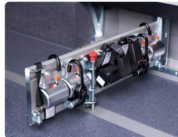
09 Diverse Einrastpositionen und verschiebbare Tragarme ermöglichen die sichere Befestigung kurzer oder langer Rollstühle
