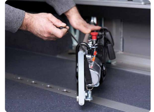
08 Einfache Entriegelung der Tragarme mit einem Handgriff
