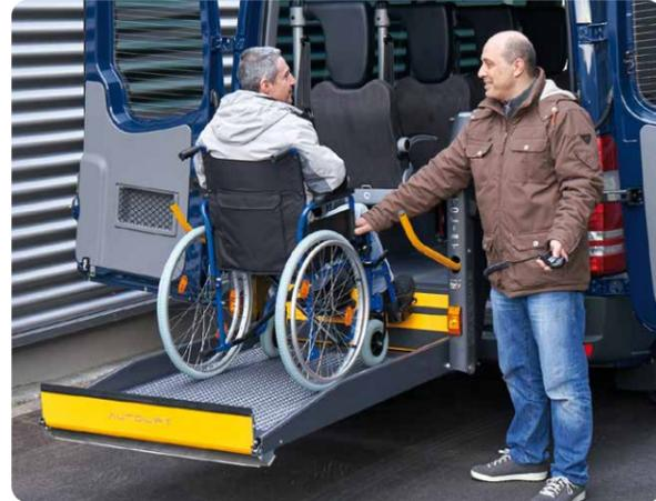
02 Sicherheit durch automatischen Rückrollschutz
