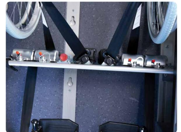
10 Alles am mittleren Tragarm: Hintere Verspannung und Beckengurt für den vorderen Rollstuhl, vordere Verspannung für den hinteren Rollstuhl
