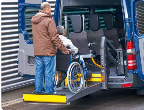
01 Einfacher Zugang mit Rollstuhl per Lift
